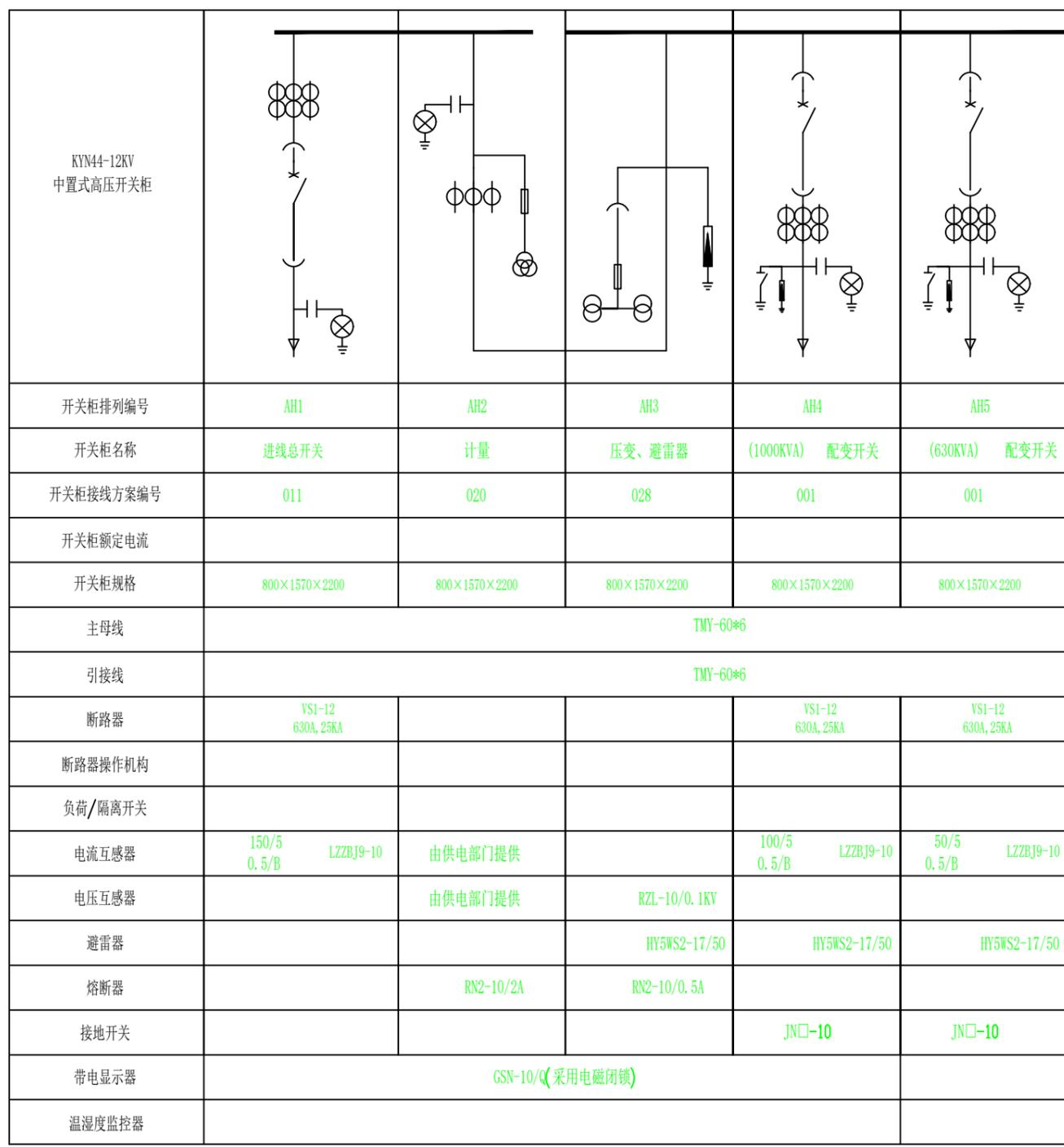
注：1、KYN44-12KV中置式高压开关柜均为电缆上进、上出线，继保要求设过流、速断，采用PDN3204S微机继电器；
